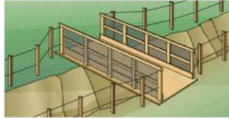
Figura 5 – Passarela em escavação para circulação de pessoas
